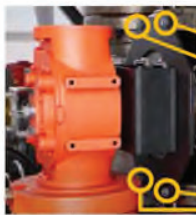
รูปที่ 1 ชี้นำให้เห็นข้อผิดพลาดที่พบบ่อยของ actuator เชื่อมกับตัววาล์ว
